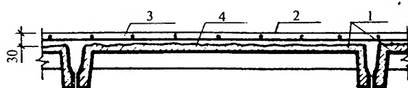
Рис. 1. Нарращивание сверху сборных ребристых плит при обеспечении сцепления поверхностей
