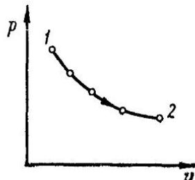
Рис. 4.1. Изображение термодинамического процесса в  $v-p$ -диаграмме
