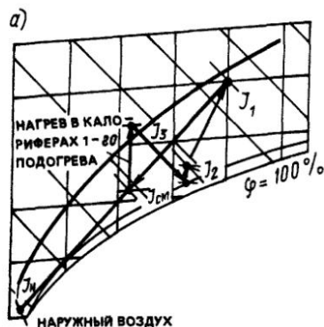
Рис. 15.6. Схемы обработки воздуха в системе, работающей с переменными расходами наружного и рециркуляционного воздуха (а и б) и с постоянными расходами (а и в), при условии, что расход наружного воздуха меньше вычисленного по формуле (15.16)
