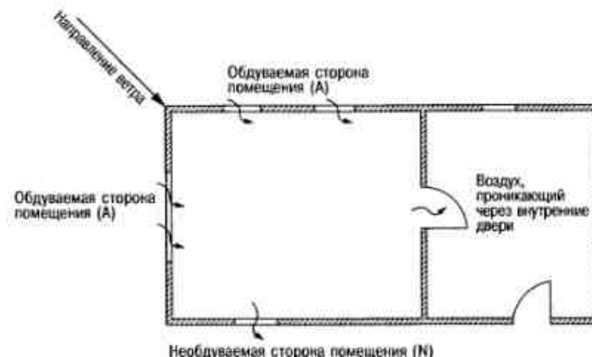
Рис. 3.2. Обдуваемые и необдуваемые стороны помещения, согласно DIN 4701
