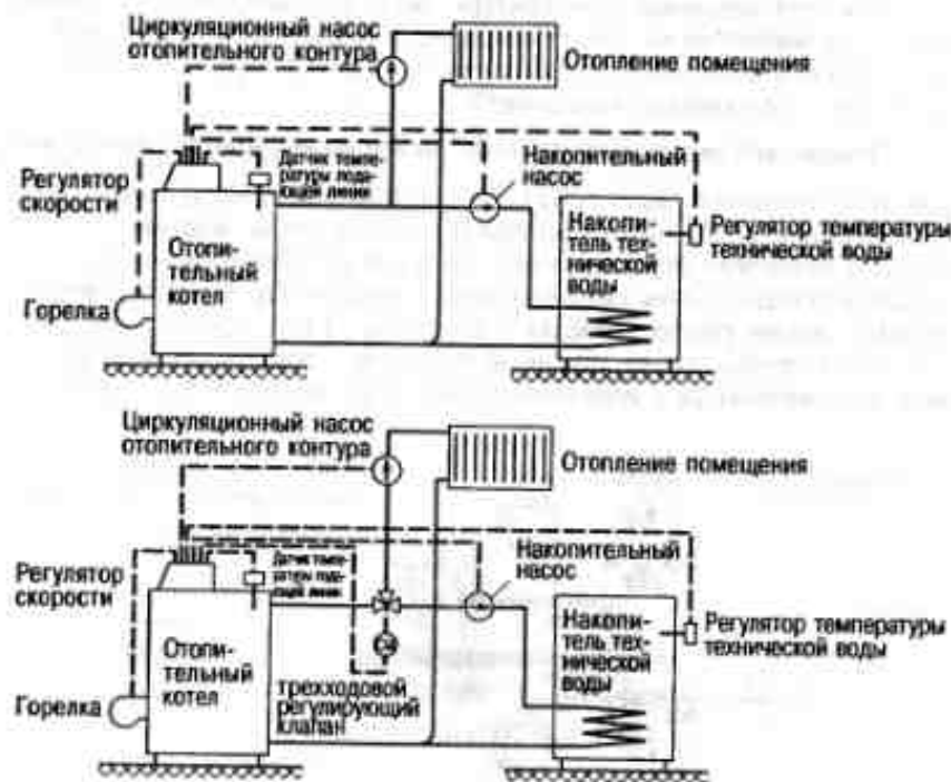
Рис. 9.27. Варианты подключения нагревателя технической воды [4.1]
