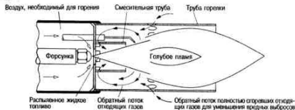
Рис. 5.4. Реактивный принцип смешения с обратным потоком отходящих газов [4.1]
