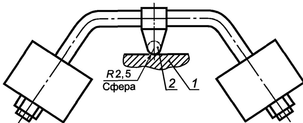
1 — образец; 2 — стальной шарик диаметром 5 мм
