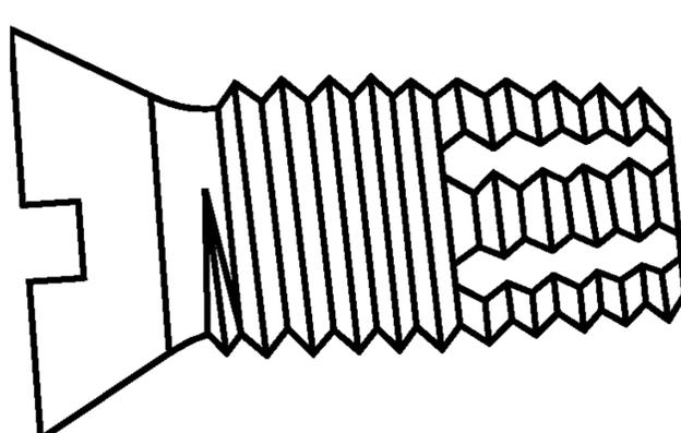
Рисунок А.7 — Самонарезающий режущий винт
