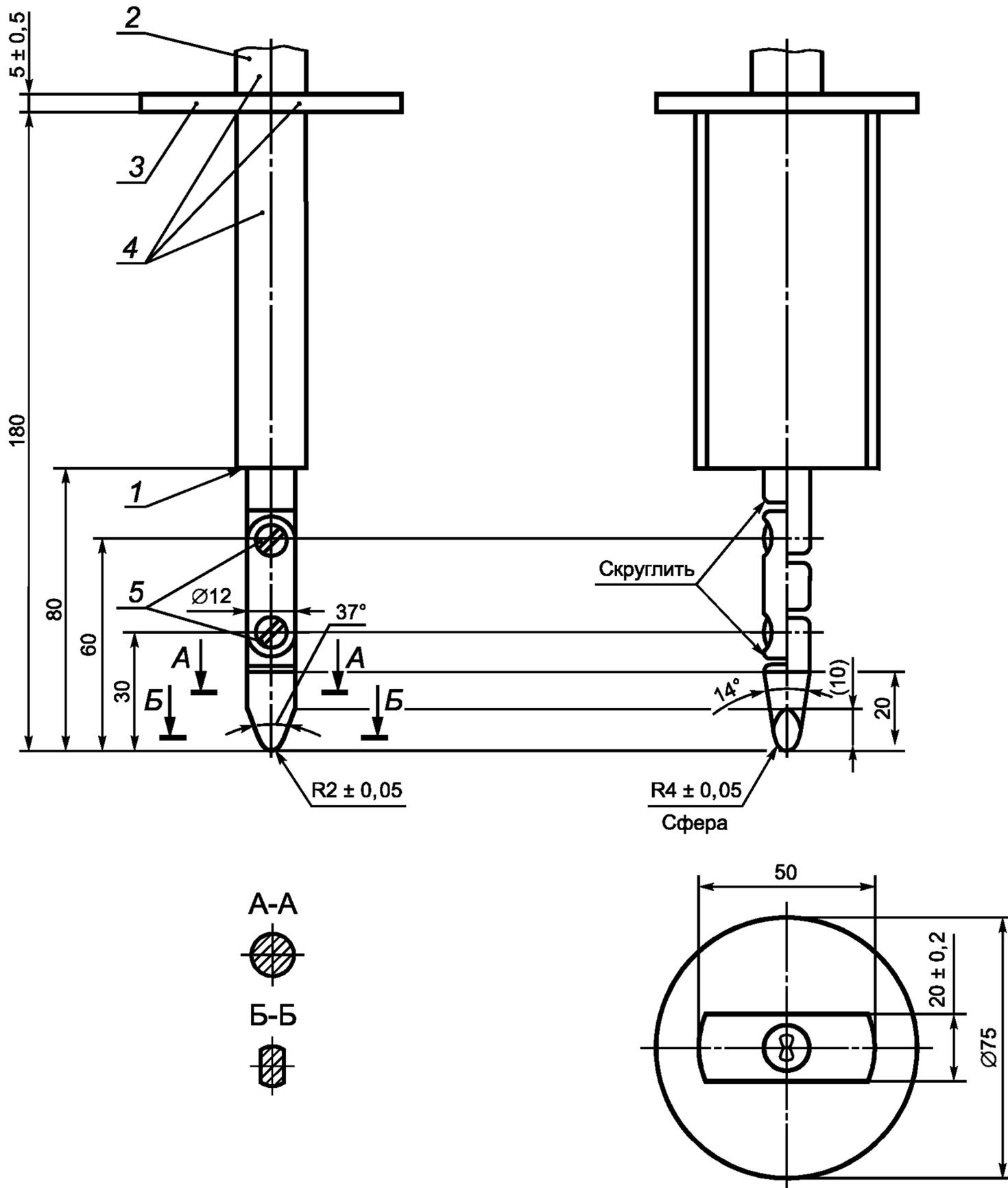
1 — упор; 2 — рукоятка; 3 — ограждение; 4 — изоляционный материал; 5 — соединение
