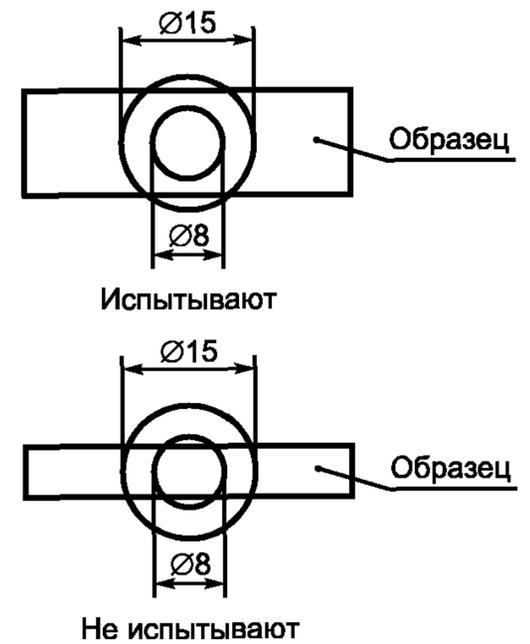
Рисунок А.31 — Схема испытания по 24.1.1
