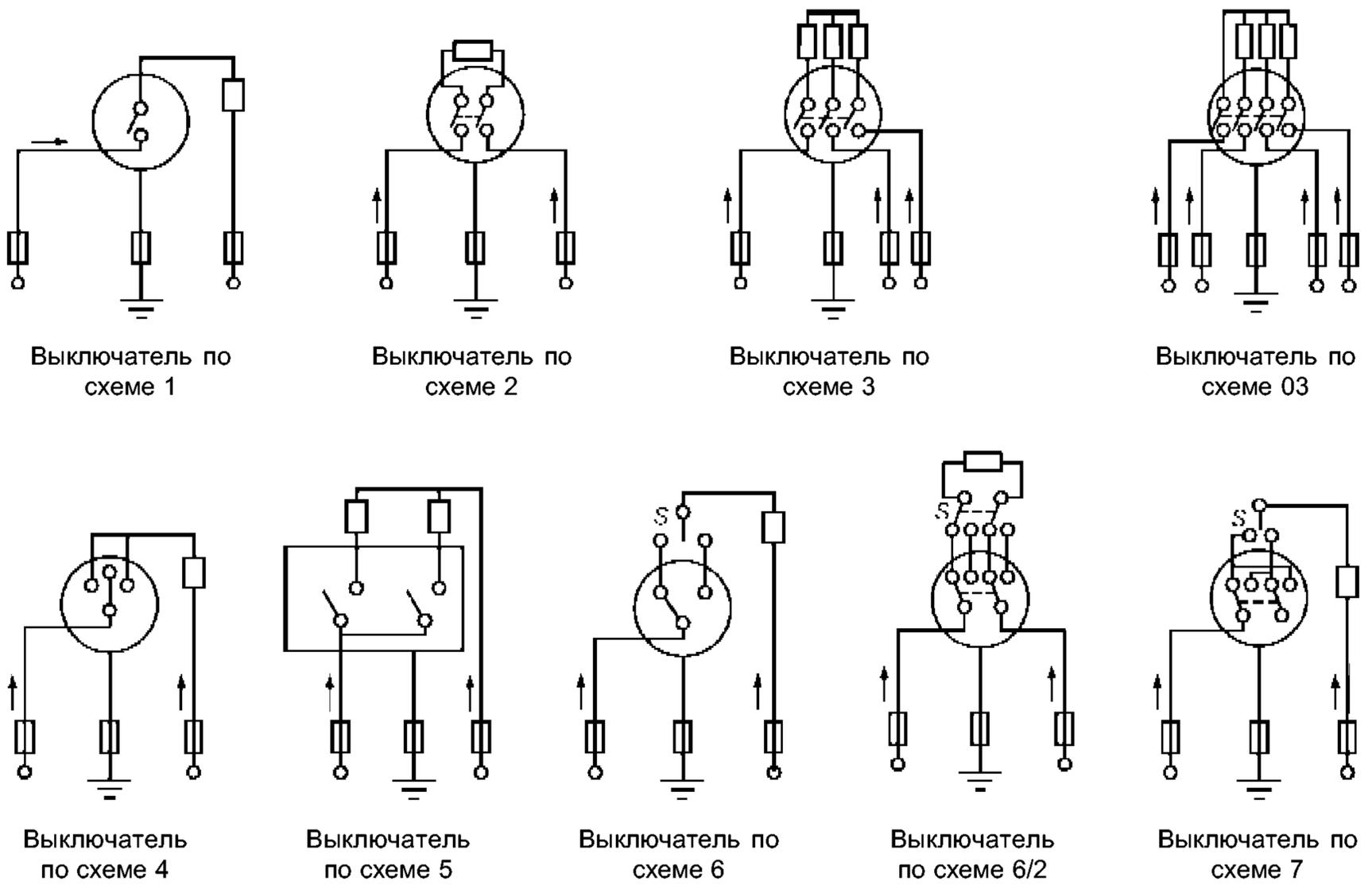
Стрелки, показывающие соединение фазных проводников, приведены исключительно в качестве примера. Если обозначения предприятия—изготовителя указывают другой порядок соединений, то необходимо следовать этим обозначениям.
