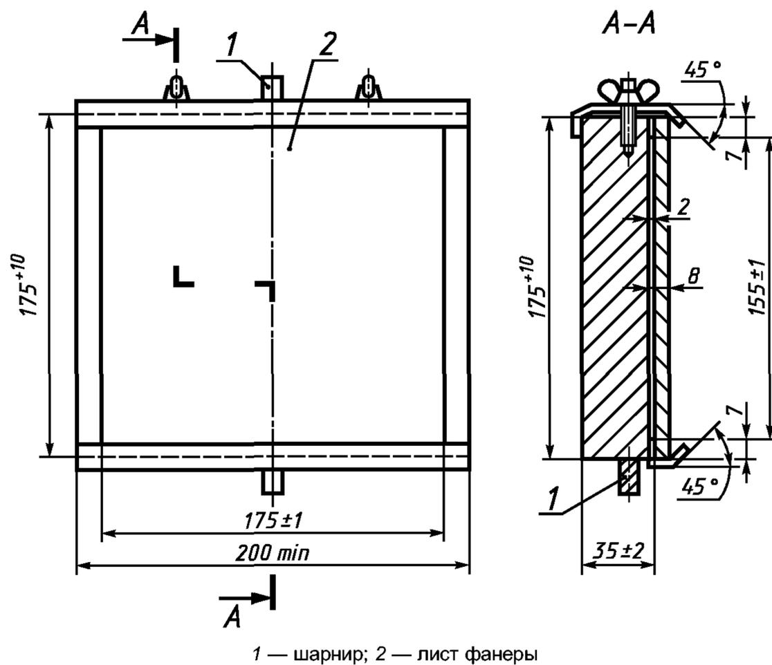
Рисунок А.21 — Основание для крепления образца
