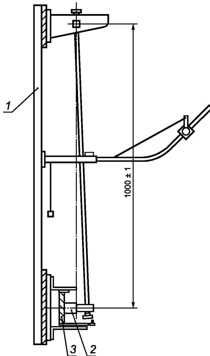
1 — рама; 2 — образец; 3 — основание для крепления образца
