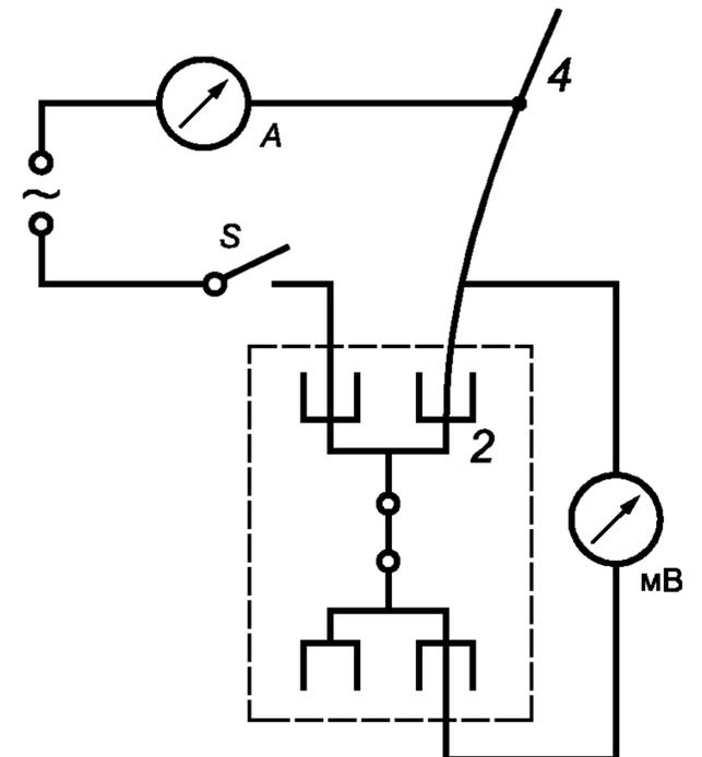
б) Принципиальная схема для определения падения напряжения во время испытаний на изгиб безвинтовых контактных зажимов
