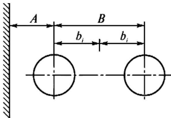
2. Расстояние между нижней образующей или теплоизоляционной конструкцией и полом или дном канала должно быть не менее 100 мм.
