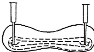
Рис. 10. Схема отработки выработки с периодической циркуляцией растворителя между скважинами
