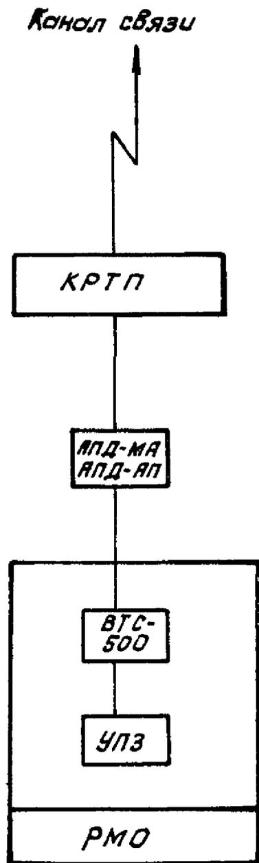
Рис. 14. Структурная схема типового решения размещения технических средств на I кассу: АПД-МА - аппаратура передачи данных; КООД - коммутатор окончного оборудования данных; ВТС-500 - видеотерминальный субкомплекс; УПЗ - устройство печати знаковосинтезирующее; КРТП - коробка телефонная; РМО - рабочее место оператора-кассира
