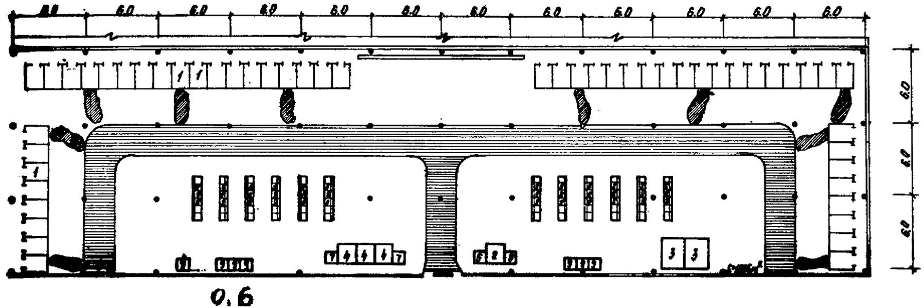
Рис. 12. Планировочная схема операционного зала агентства производительностью 800 билетов в час (I вариант): 1 - кассовая кабина; 2 - справочное бюро; 3 - киоски; 4 - касса автобуса; 5 - тумба информационная; 6 - телеинформационная система наличия мест; 7 - СВТУ; 8 - кресла для отдыха; 9 - автомат газированной воды
