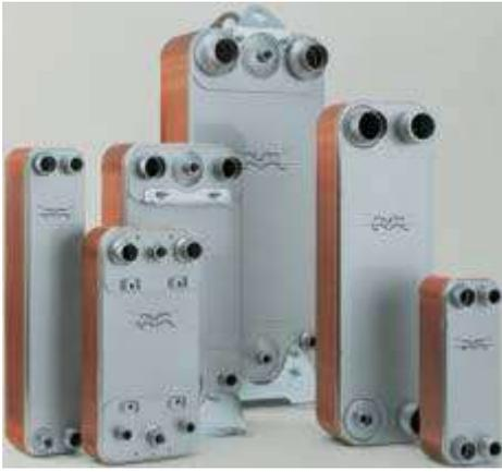
В паяных теплообменниках из нержавеющей стали не нужны прокладки и прижимные плиты. Припой надежно соединяет пластины в точках контакта и уплотняет пакет пластин. Пластинчатые теплообменники Alfa Laval спаяны во всех точках контакта, это обеспечивает оптимальный КПД теплопередачи и высокое сопротивление давлению. Конструкция пластин рассчитана на долгий срок эксплуатации.
