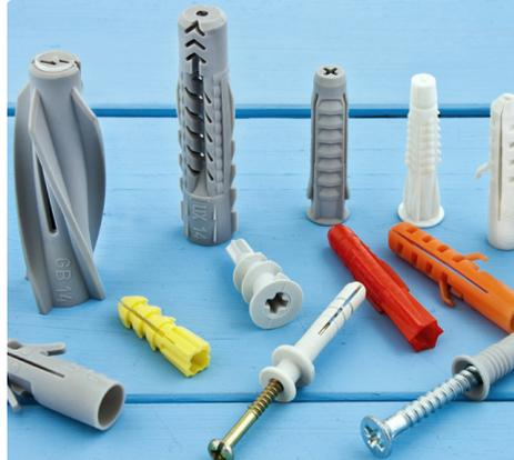
Дюбеля из полиэтилена и полипропилена вполне подходят для проведения внутренних работ. Их можно использовать в том числе в помещениях с высокой влажностью и даже в агрессивных средах (к примеру, на производственных площадках). Однако следует помнить, что со временем они теряют свои эластичные свойства и несущую способность, а потому для ответственных высоконагруженных соединений их лучше не использовать.
