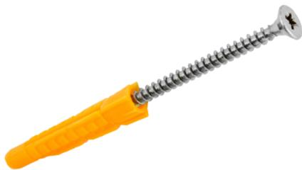
Распор дюбеля происходит как правило в двух плоскостях. В зависимости от типа стены будут работать разные механизмы удержания: при полнотелой расширяющаяся часть раздвигается до упора и удерживается за счёт сил трения (работает как распорный дюбель); при пустотелой – основание пройдёт насквозь, а за счёт деформации второго края образуется анкерное крепление. Благодаря своей конструкции при установке в пустотелые материалы он скручивается в узел.
