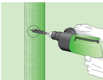
Шаг 3. По нанесенной разметке просверлить отверстие в торце двери.
