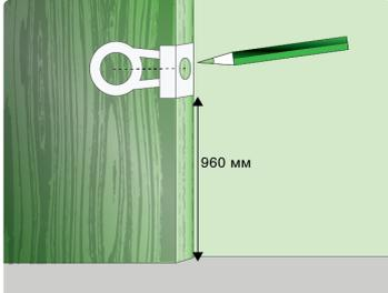
Шаг 1. Разметить высоту установки ручки от пола, учитывая, что рекомендуемая стандартами высота составляет 960 мм. По шаблону нужно разместить два основных отверстия: сквозное — 50 мм на полотне двери, и отверстие 25 мм в торце двери. Оси отверстий должны находиться в одной плоскости.
