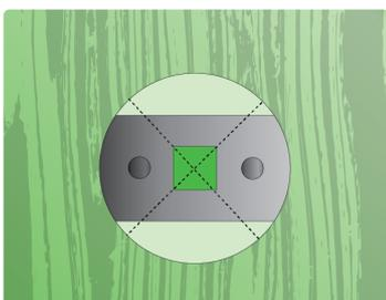
Квадрат под ручку при этом должен находиться в центре отверстия 50 мм. Защелку нужно плотно прижать к торцу двери, обеспечив ее положение посередине торца параллельно плоскости двери.
