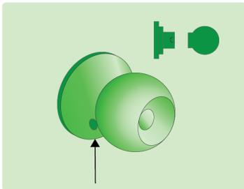
Шаг 7. Снимите внутреннюю часть ручки с декоративной накладкой, отжав подпружиненный фиксатор, расположенный в нижней части ручки.
