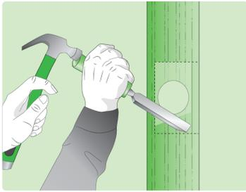
Шаг 5. С помощью стамески и молотка сделать углубление в торце на требуемую глубину, чтобы установить крепежную планку заподлицо с торцом двери.
