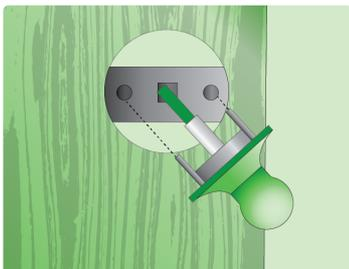
Шаг 9. Установите внешнюю ручку с накладкой и внутреннюю пластину, вставив стержень и стяжные винты в предназначенные для них отверстия без натяга.
