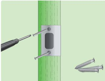
Установите планку на два самореза из крепежного комплекта.
