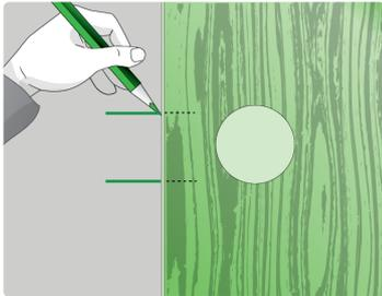
Шаг 6. Закрывать дверь и по имеющейся разметке крепежной планки выполнить разметку (высоту установки) ответной планки.
