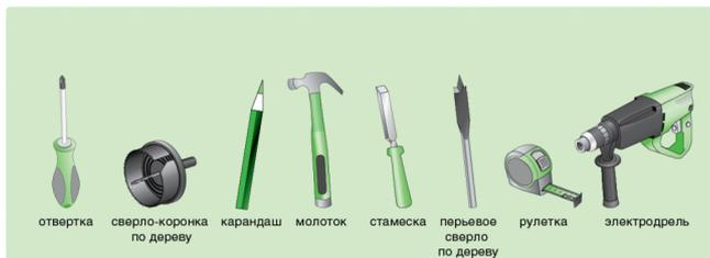
Дрель, сверло перьевое по дереву диаметром 25 мм, сверло-коронка по дереву диаметром 50 мм, стамеска или долото, отвертка, молоток, рулетка, карандаш или маркер.
