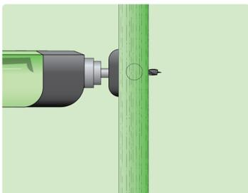
Шаг 2. Нужно сделать отверстие 50 мм, высверлив его сначала с одной стороны на такую глубину, чтобы центральное сверло коронки появилось с другой стороны и завершить сверление, вставив стержень коронки в просверленное отверстие с другой стороны дверного полотна.
