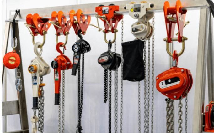
Разрывная и рабочая прочность зависят от диаметра прутка, качества используемого материала и технологии производства цепи. В среднем разрывная нагрузка в 4 раза выше рабочей.
