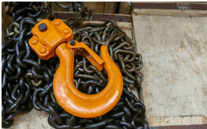
Это калиброванные короткозвенные цепи с классом 8 и выше. Предел их прочности начинается при разрывной нагрузке от 800 Н/мм<sup>2</sup>. Такие цепи делаются из закалённой высоколегированной стали.
