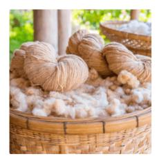
Хлопок обладает средней гигроскопичностью и великолепными механическими свойствами. Изготовленные из него канаты, к примеру, очень эластичные, термостабильные, с хорошими диэлектрическими свойствами. К минусам можно отнести среднюю стойкость к воздействию УФ-излучения, невозможность противостоять кислотам и щелочам, а также истирание. Из-за подверженности гниению все изделия из хлопка подлежат обязательной пропитке специальным средством.
