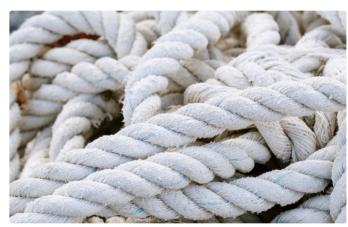
К минеральному сырью чаще всего относят асбест. Такие шнуры обладают низкой устойчивостью к разрыву, но они очень огнестойкие. Именно поэтому их чаще всего применяют для обустройства ответственных узлов в пожароопасных зонах, для подвязки дымоходных труб из стали, а также раскалённых конструкций.
