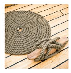
Полиэфир, или полиэстер, уступает нейлону по прочности, но не теряет её во влажном состоянии. Устойчив к воздействию солнечного света, мало подве уступанию, долговетер. Особенность — низкая эластичность — определяет и область применения таких верёвок — Такеламу, подвешиваний гамаков, установка палаток и так далее.
