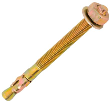
По сути это модифицированный вариант стандартного анкера с гайкой. Конструктивное отличие состоит в том, что втулка расположена на его конце, а не выступает в качестве корпуса. Кроме того, под гайку для равномерной нагрузки подложена шайба. Данный тип крепежа применяется для монтажа конструкций значительной массы, в том числе на потолок.
