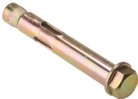
Такой анкер состоит из болта с резьбой, гильзы и конусообразной цанги, выступающей в качестве распорного элемента. Производится из оцинкованной стали, что обеспечивает защиту от коррозии.
