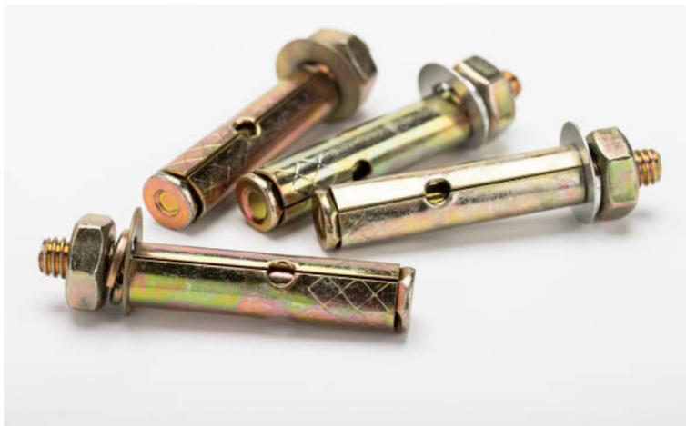
Это самый простой и надёжный вариант крепежа. Состоит из резьбовой шпильки с конусом на конце, распорной втулки и гайки. Такие анкерные болты подходят для монтажа в бетонные конструкции, кирпичные стены и природный камень.
