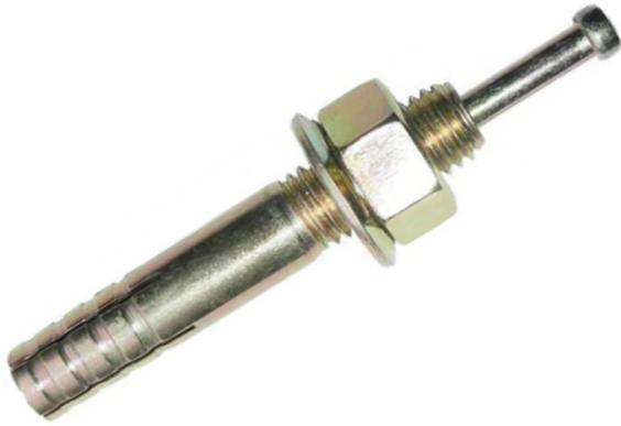
Применяются для монтажа массивных конструкций в случаях, когда эстетическая сторона не играет роли. Такой крепёж состоит из металлического стержня, на верхней части которого выполнена резьба для гайки, нижняя является распорной муфтой. Также в систему включён ударный элемент, гвоздь, который забивается в стержень и разжимает муфту.
