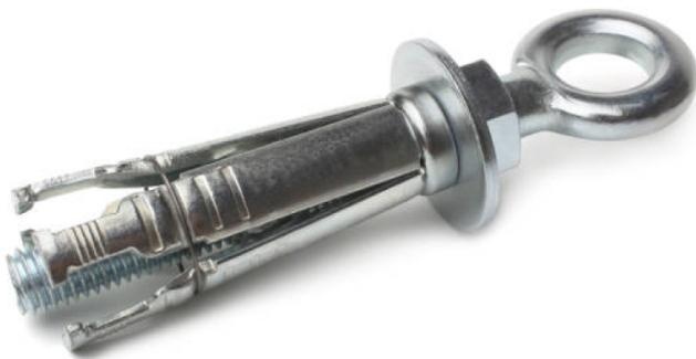
Конструкция анкера не предусматривает наличие клиновой части. В этом случае муфта, разделённая на четыре сегмента, расширяется при вкручивании болта. Он, в свою очередь, перемещает во внутренней полости четырёхгранный элемент.
