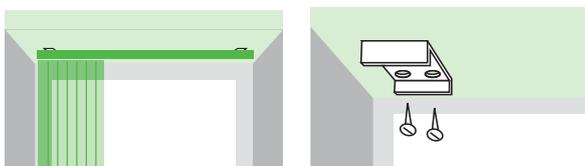
**Крепление к потолку:** жалюзи устанавливаются прямо на потолок или на верхнюю часть оконного проема.
