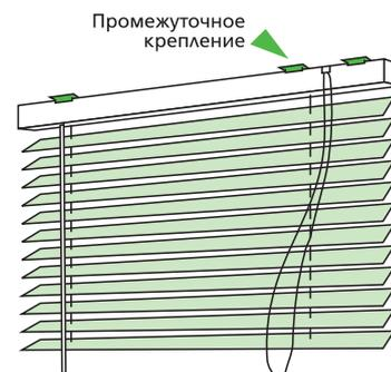
Разместите дополнительное крепление на расстоянии 10 см от регулирующего шнура (в этом месте механизм жалюзи испытывает небольшую нагрузку).
