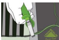
Снимите изоляцию в местах подсоединения термопленки к наконечнику. Подведите оголенный провод к наконечнику и плотно зажмите его с помощью пассажей.
