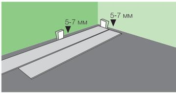
В связи с возможными расширениями и сжатиями пола, необходимо с помощью клиньев соблюдать отступы (5-7 мм) от стен, труб и всех фиксированных объектов, дверных проемов, сводов, углов комнат в помещениях больше, чем 8 x 12 м.
