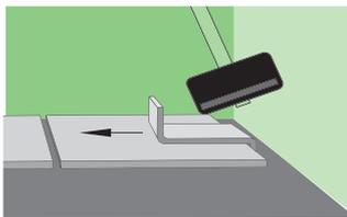
Для монтажа последней доски у стены используется скоба (струбцина).
