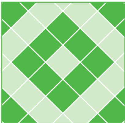
**Под углом:** при покупке плитки следует предусмотреть запас на подрез около 10%
