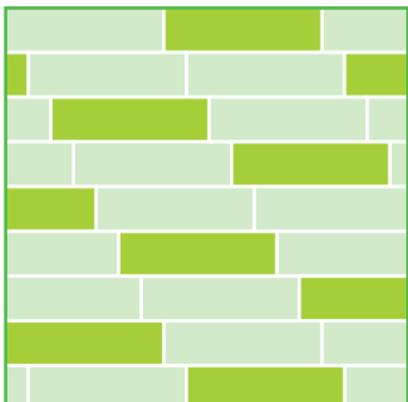
**Укладка «со сдвигом»:** подходит для прямоугольного формата плитки. При подобной раскладке не рекомендуется сдвигать соединение более чем на половину от длины плитки
