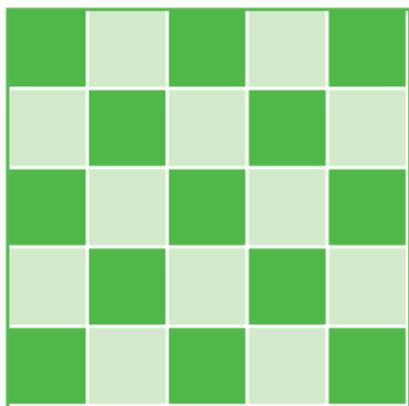
**Простая укладка:** самый простой и распространенный рисунок укладки
