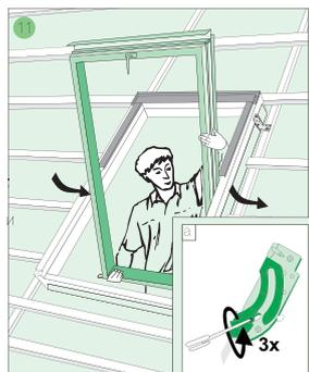
**11.** Вставить створку окна в оконную коробку. Для этого необходимо: взять створку в руки (рис. 11), наружным стеклом к себе, а низ окна кверху; удерживая створку в вертикальном положении, вложить её снаружи в петли равномерно без перекоса; выкрутить блокировочные винты на три оборота против часовой стрелки (рис. 11 а), и закрыть окно;
