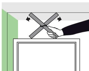
3. Для того, чтобы зафиксировать дверной блок в вертикальном положении, вставьте между его верхним краем и потолком крест, сделанный из двух деревянных клиньев, соединенных между собой в центре толстой резиной (например, от автомобильной камеры).
