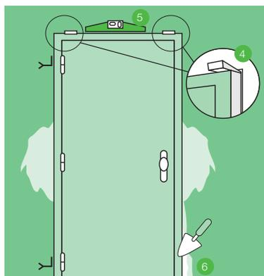
4. Установите дверной блок в проеме и закрепите его с помощью деревянных клиньев.
