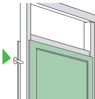
Вставьте вертикальные части каркаса в пазы дверной коробки. Привинтите дверную коробку изнутри к каркасу. Обшейте каркас листами гипсокартона.
