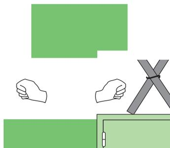
2. Разрежьте гипсовые блоки таким образом, чтобы заполнить ими все пространство вокруг дверной коробки. Зафиксируйте блоки на верхней перекладине дверной коробки с помощью монтажного клея.
