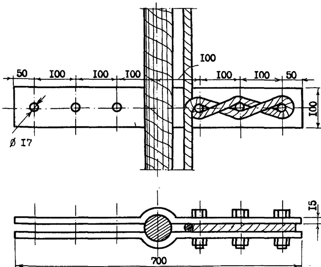
Рис. П.2. Вариант "глухого" закрепления кабеля к тросу
