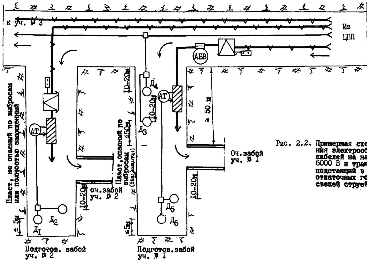
Рис. 2.2. Примерная схема размещения электрооборудования, кабелей на напряжение 6000 В и трансформаторных подстанций в выработках откаточных горизонтов со свежей струей воздуха
