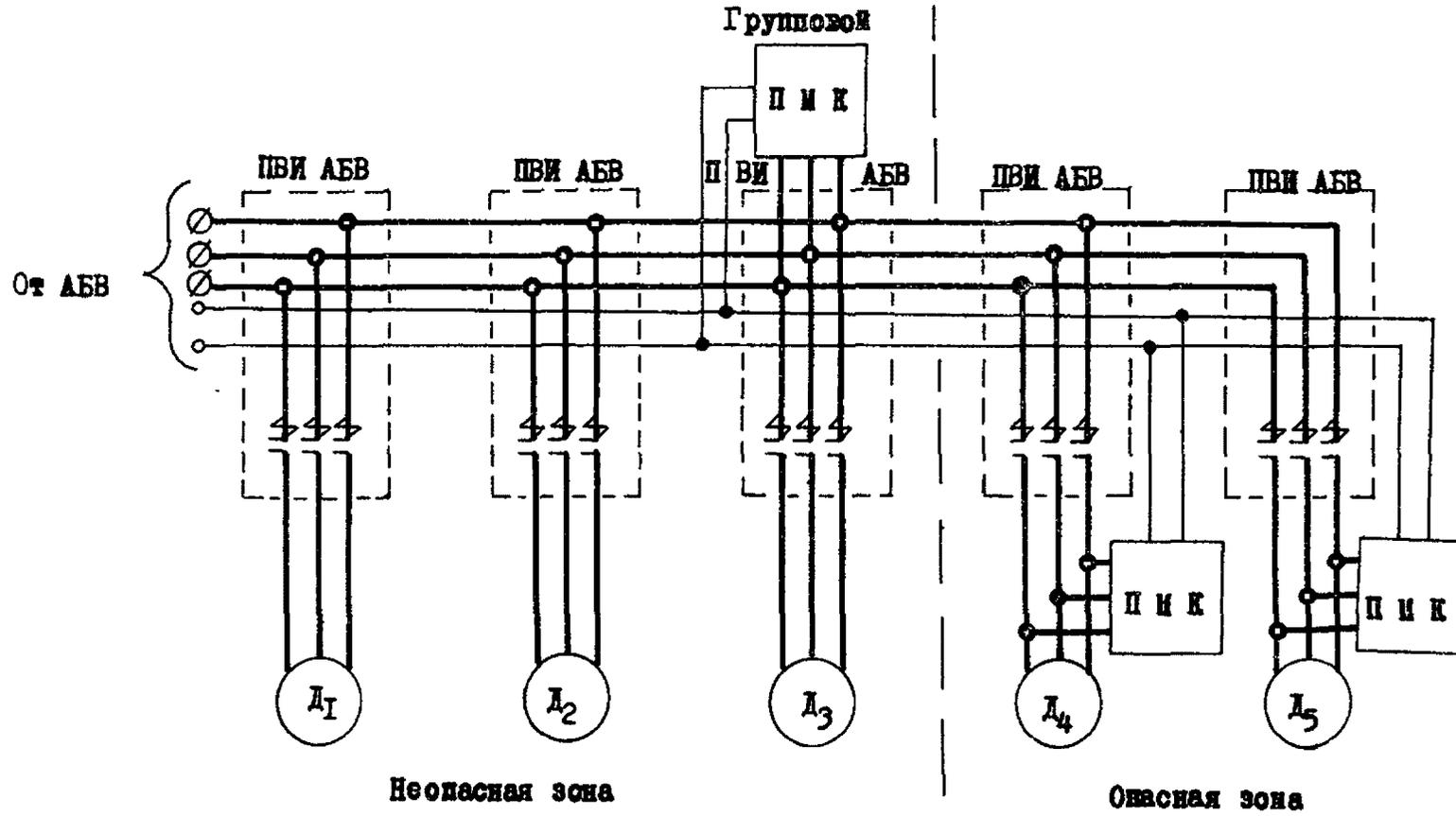
Рис. 2.11. Принципиальная электрическая схема расположения и присоединения короткозамкнателей в сети быстродействующего автоматического выключателя АБВ с группой ПМК.
