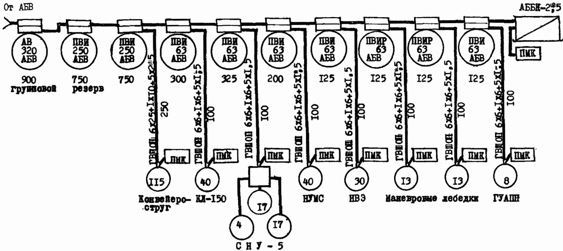
Рис. 2.16. Примерная схема распределителя РП Д 3
