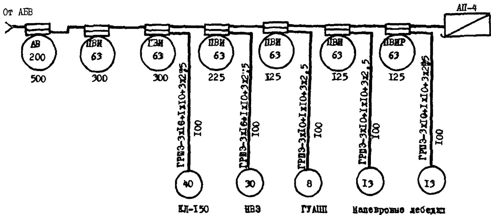
Рис. 2.15. Примерная схема распределителя РД В 2 без быстрого действия защитного отключения напряжения
