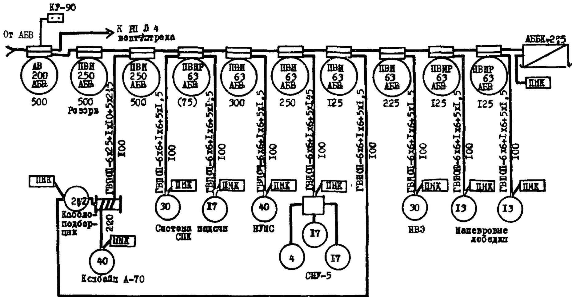
Рис. 2.12. Примерная схема распределения РП В I
