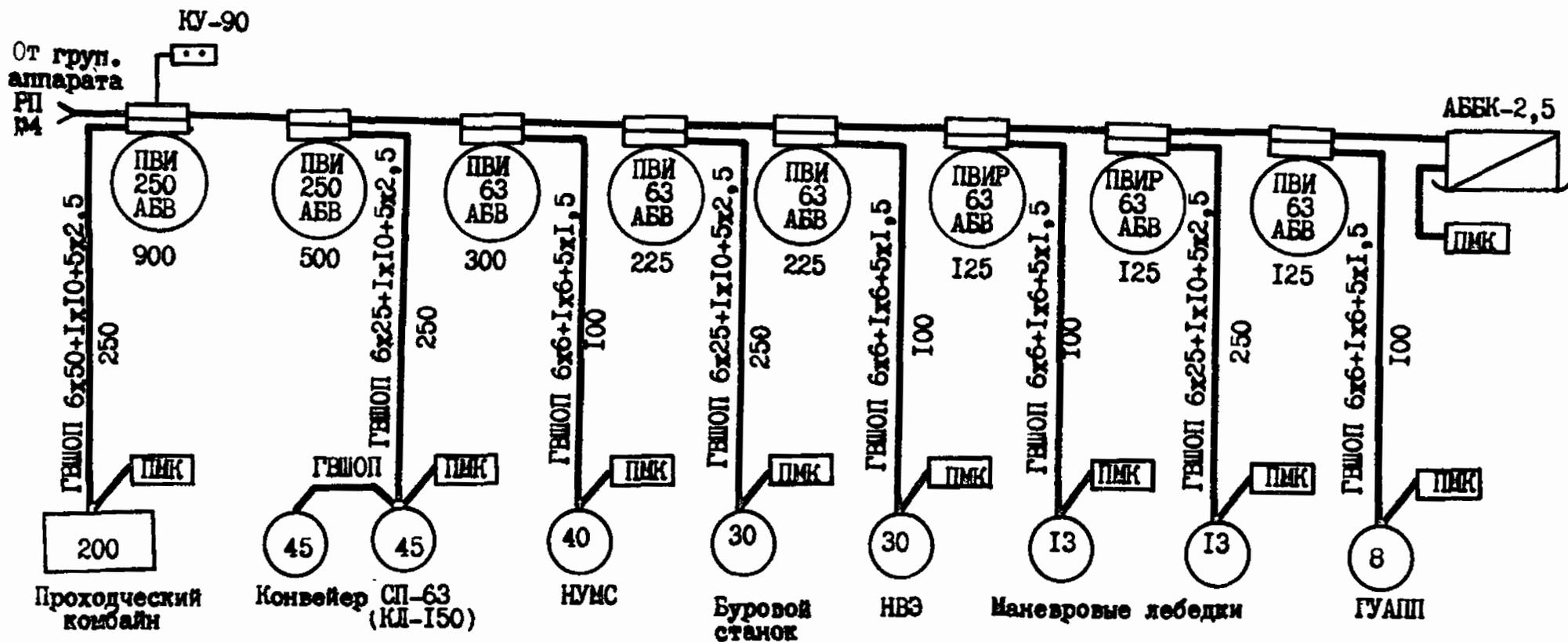
Рис. 2.23. Примерная схема распределителя РП № 6
