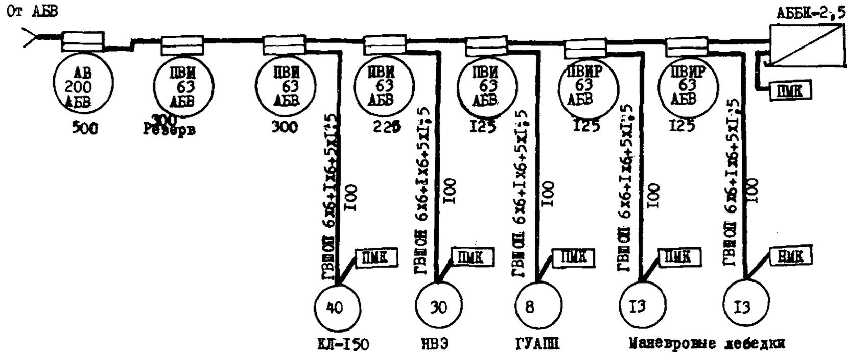
Рис. 2.14. Примерная схема распределения ПИ № 2
