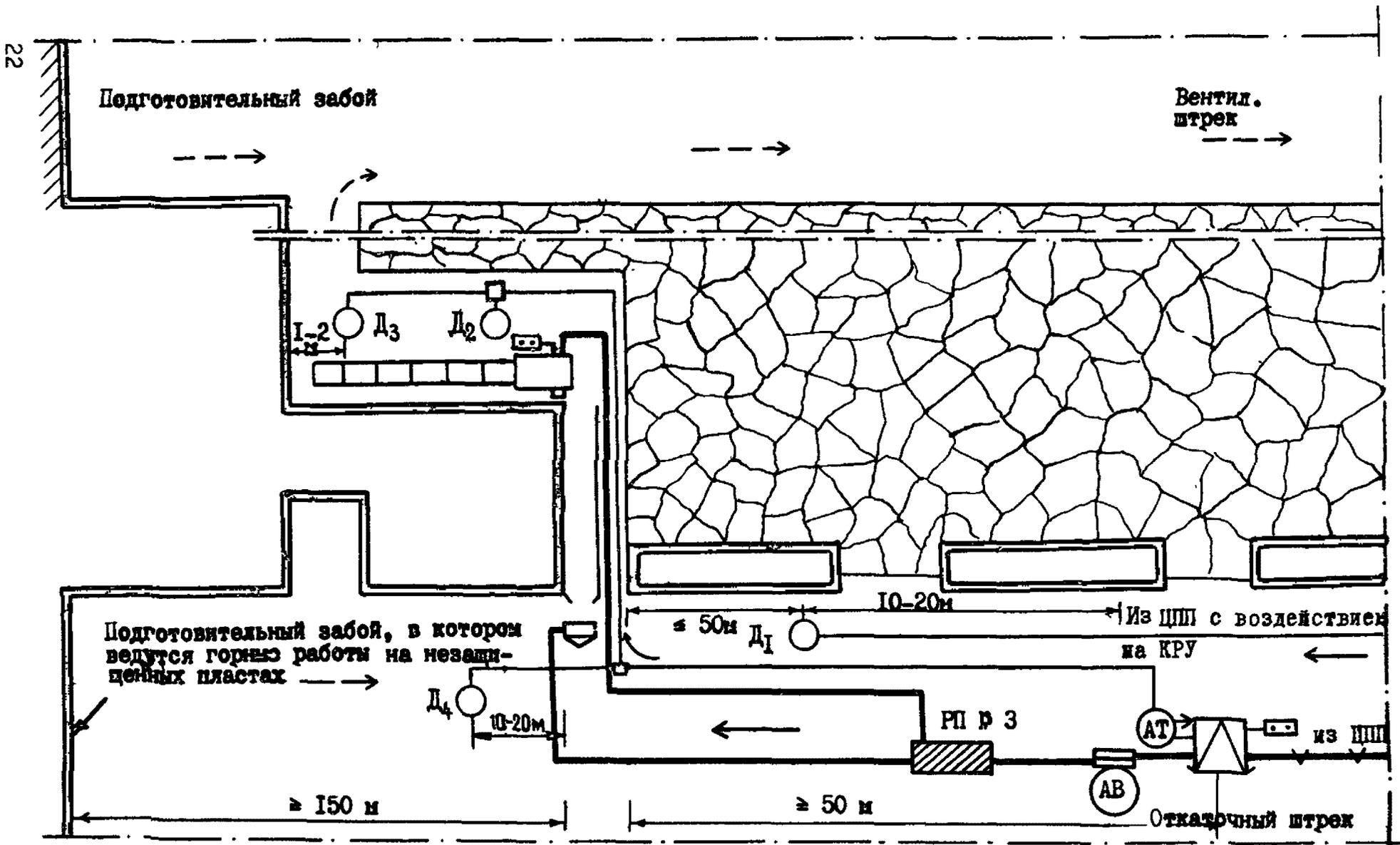
Рис. 2.5. Примерная схема размещения электрооборудования и кабелей систем электроснабжения без быстрого защитного отключения напряжения в очистном забое, оборудованном щитовым агрегатом на пласотах, опасных по внезапным выбросам, разрабатываемых без задражки
