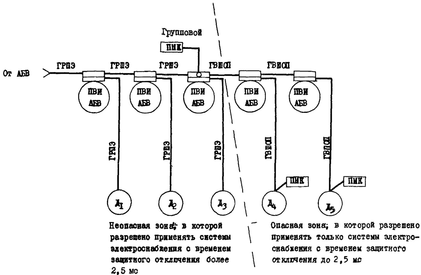
Рис. 2.10. Структурная схема расположения короткозамыкателей в сети быстродействующего выключателя АБВ с групповым ПМК
