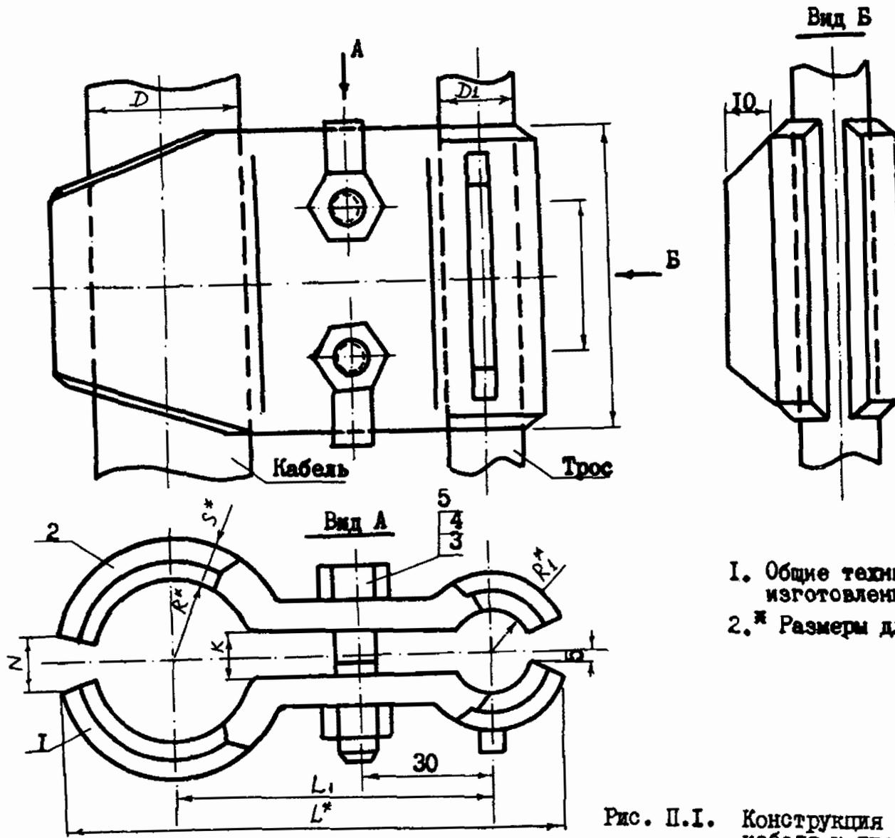
Рис. П.І. Конструкция зажима для крепления кабеля к тросу
