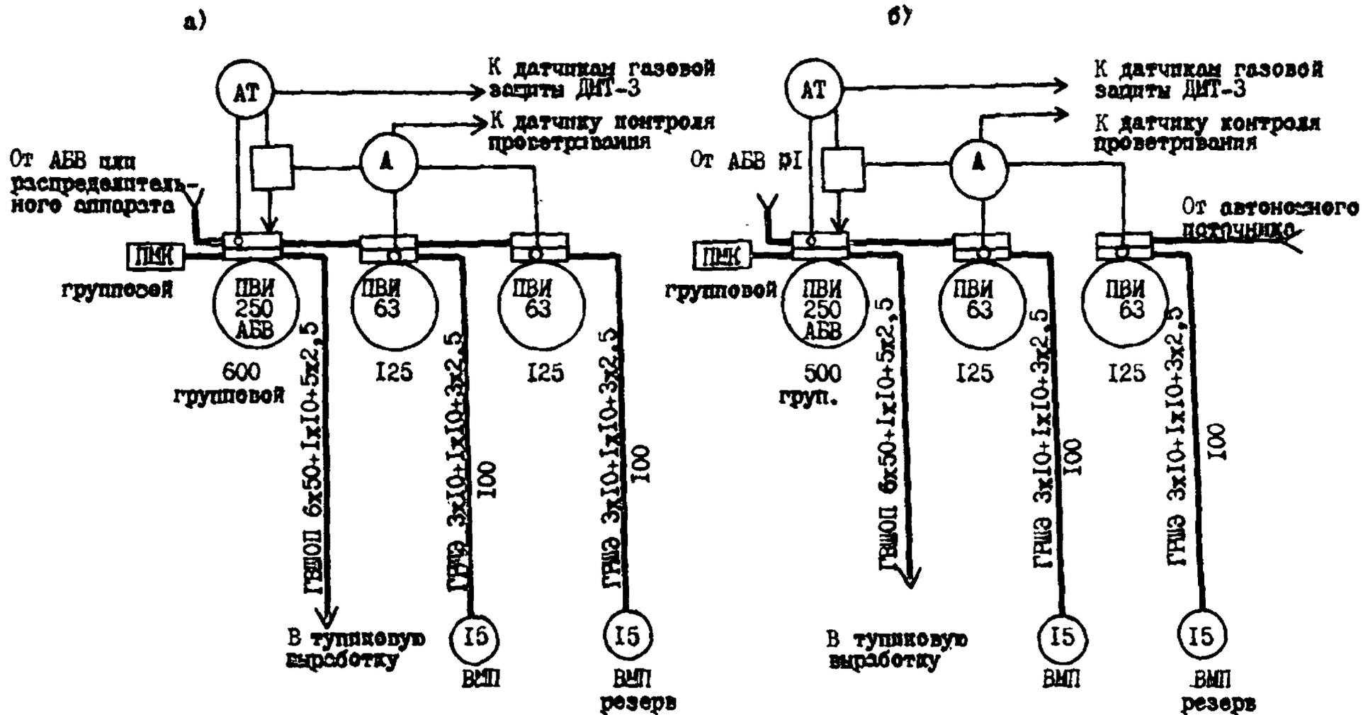
Рис. 2.20. Примерные схемы распределителя ПИ Д 4 при использовании быстродействующего защитного отключения напряжения только в тупиковой выработке
