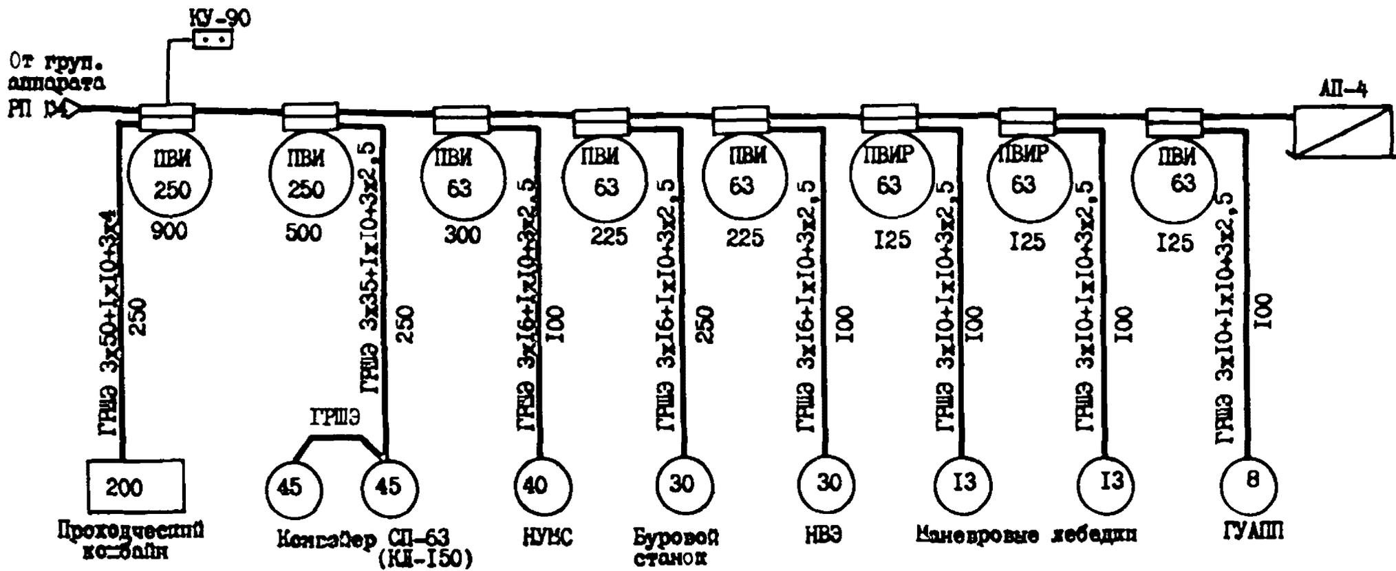
Рис. 2.24. Примерная схема распределения ПИ Д 6 без быстродействующего защитного отключателя напряжения
