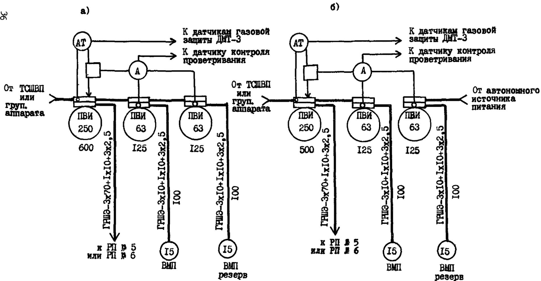
Рис. 2.19. Примерные схемы распределителя РП № 4 без быстрогодействующего защитного отключения напряжения:
