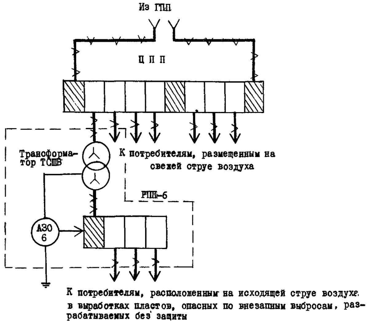
Рис. 2.1. Примерная структурная схема ЦПП шахты, разрабатывающей крутые выбросоопасные пласты; и РПН-6 с разделительным трансформатором
