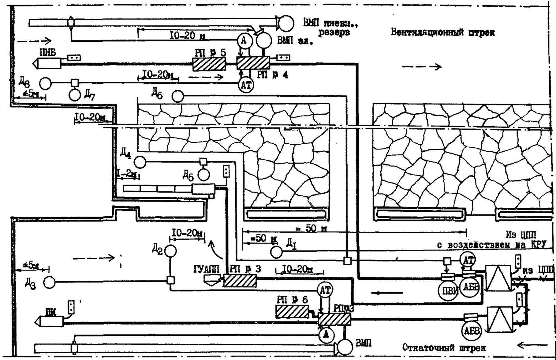
Рис. 2.4. Примерная схема присоединения к трансформаторной подстанции и размещения электрооборудования на участке с забоями, оборудованными штовым агрегатом, проходческим комбайном и породопогрузочной машиной для пластов, опасных по внезапным выбросам, не имеющих защиты
