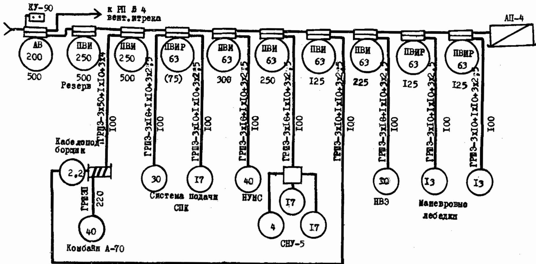
Рис. 2.13. Примерная схема распределителя ПИ № 1 без
