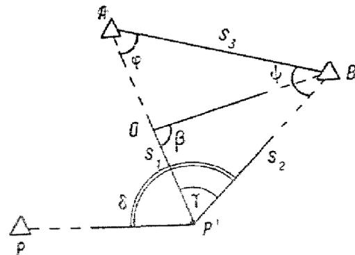
Рис. 4. Отыскание центра пункта по двум видимым геодезическим пунктам
