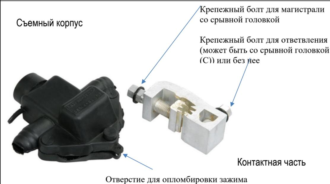
Рисунок 2 Зажим ответвительный с отдельной затяжкой болтов ЗОРЗБ
